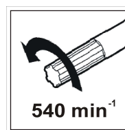
Rys. 8 Kierunek i prędkość obrotowa WOM.
